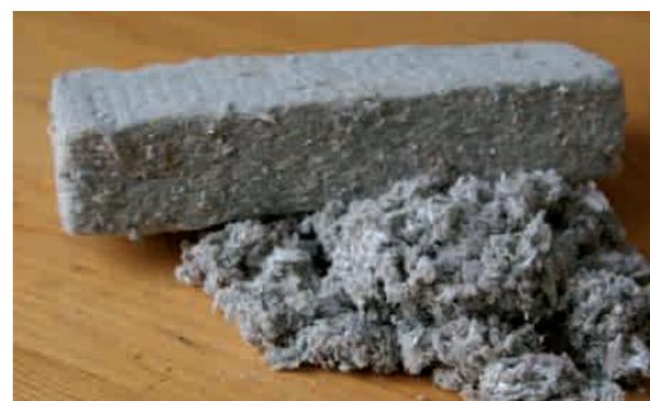
La ouate de cellulose existe en panneaux ou en vrac.
